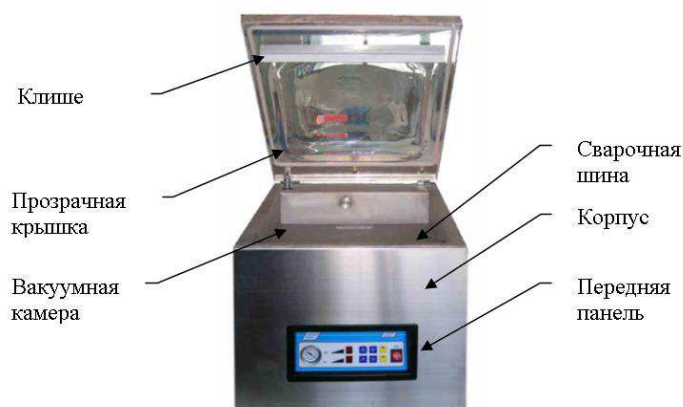
Рис.2 Состав и устройство упаковщика.
